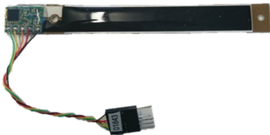
DE-Dehnungssensor (links, Quelle: www.parker.com/eap ) und DE-Linearaktormodul mit integrierter Elektronik (rechts)
