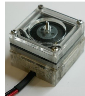
DE-Dehnungssensor (links, Quelle: www.parker.com/eap ) und DE-Linearaktormodul mit integrierter Elektronik (rechts)
