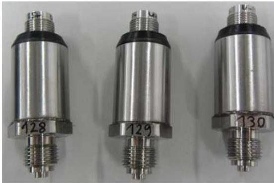
Fig. 12 Gekapselte Drucksensor-Prototypen ohne sensornahe Elektronikschaltung. In diesem Zustand können die Rohsignale charakterisiert werden.
